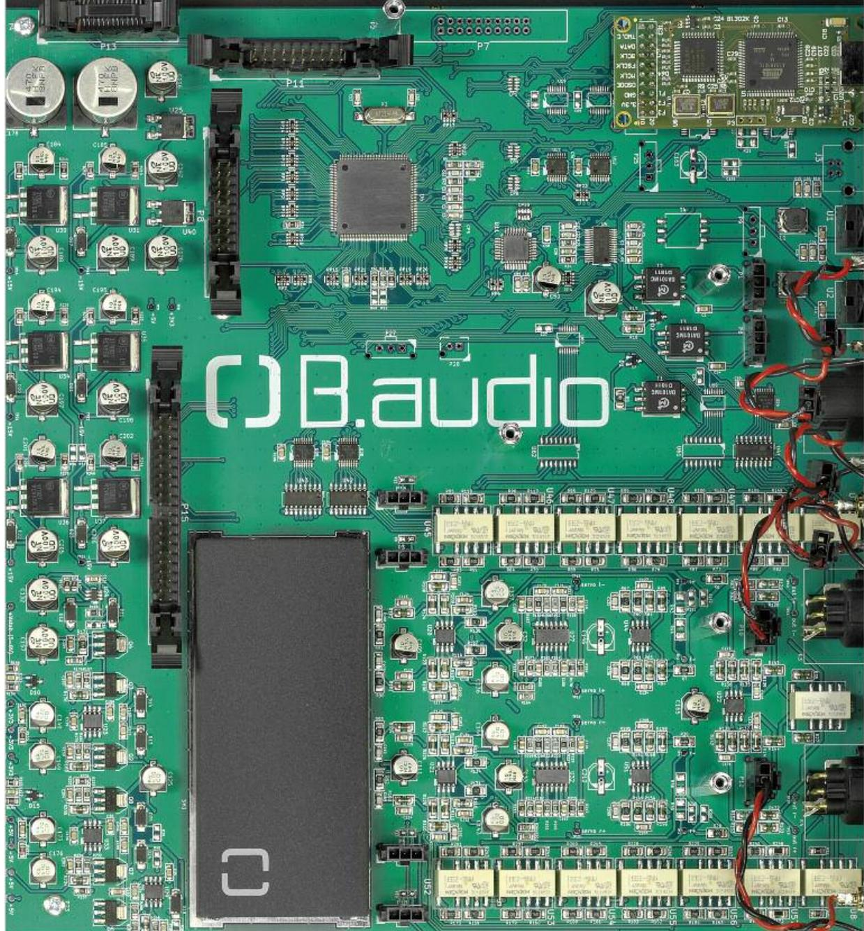
Oben: Auf der Hauptplatine des B.dpr befindet sich im Bild oben die digitale Sektion mit allen Eingängen. Das schwarze längliche Kästchen links unten verbirgt die geheimen Kernelemente des DAC. Ein ganzes Viertel der Platine nimmt rechts unten die Ausgangsstufe mit der analogen Lautstärkeregelung ein. Jeweils sieben Relais schalten das Widerstandsnetzwerk für den linken und den rechten Kanal
