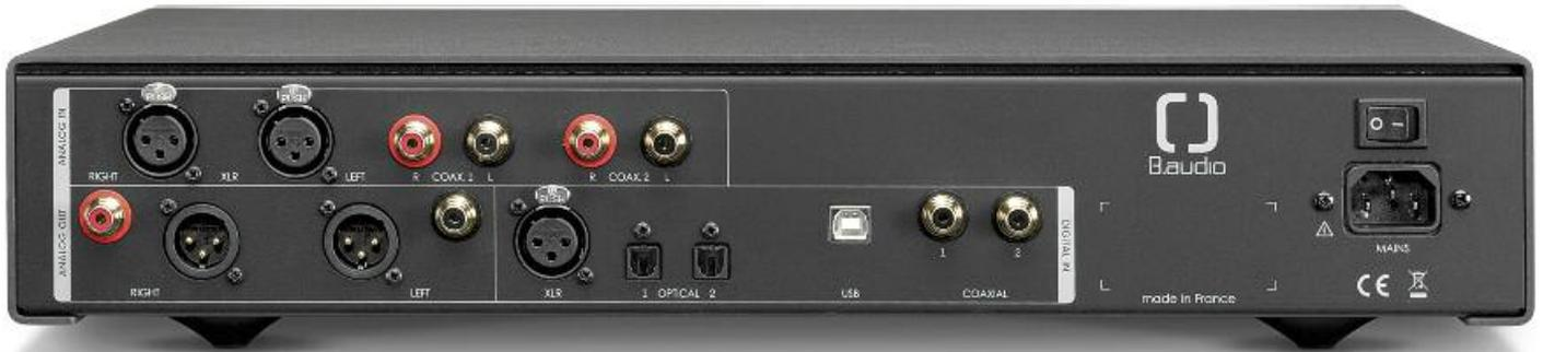
Der voll ausgestattete B.dpr umfasst oben den symmetrischen Eingang und die zwei RCA-Eingänge. Unten links befinden sich die RCA- und XLR-Buchsen für den Ausgang. Unten in der Mitte sind die digitalen Eingänge zu sehen: 1 x AES/EBU, 2 x Toslink, 1 x USB, 2 x S/PDIF
